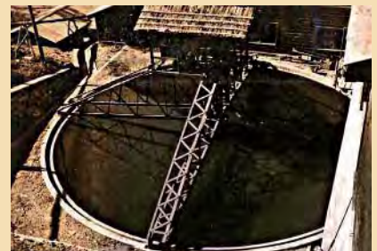
シクナー 液体中に混じる固体粒子を分離・沈殿させる装置
